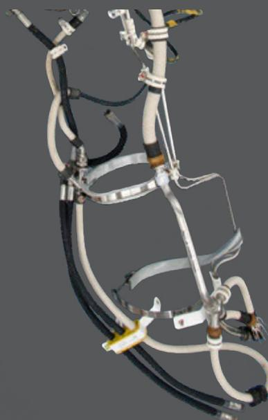
Metal-core conduit wire protection
