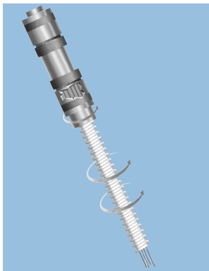
Il modello dell'accessorio per connettori a fibra ottica dipende dalla stretta attenzione alle esigenze tipiche delle trasmissioni. In questo caso la necessità di proteggere l'allineamento assiale delle estremità del contatto ha richiesto l'uso di un raccordo girevole per impedire al cavo di torcersi e danneggiare l'allineamento delle fibre.
